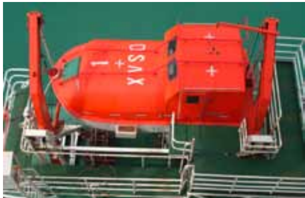
Fassmer Gravity Pivot Davit | FPD
